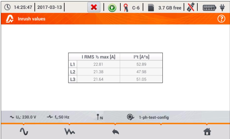
Abb. 9. Einschaltstrom – Charakteristikparameter
