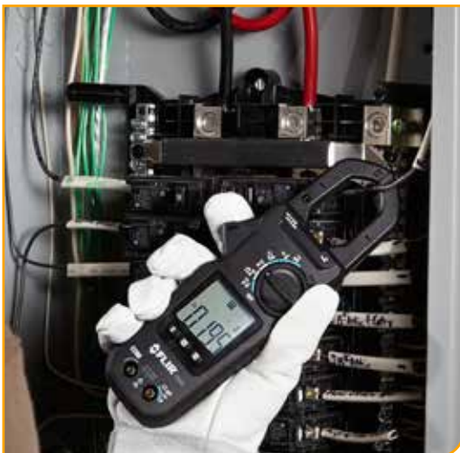
Mit Accu-Tip können Sie präzisere Stromstärkemessungen ausführen
