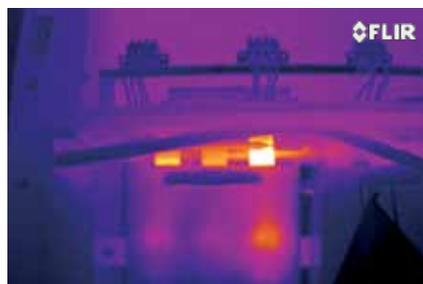
Fehlerhafte elektrische Verbindung
