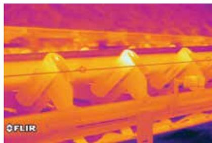
*Digital- und Wärmebild eines Rollenlagers, das überhitzt ist und ausgetauscht werden sollte*
