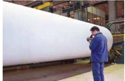
*Inspektion der Feuchtigkeitsverteilung in der Papierbahn, welche mit einer Geschwindigkeit von 1600 m pro Minute vor der Kamera vorbeiläuft*
