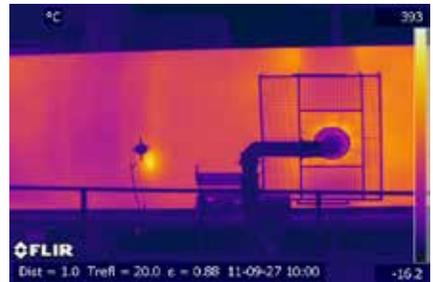
Diese Bilder sind Bestandteil einer wöchentlichen Inspektion. Die Analyse dieser Bilder gibt Auskunft über den zunehmenden Verschleiß der Feuerfestauskleidung oder Produktablagerungen im Innern.
