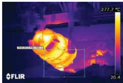
*Die Feuerfestauskleidung auf dieser Gießpfanne lässt Zeichen von Verschleiß erkennen. Wenn sich diese Tendenz fortsetzt, muss sie ausgetauscht werden. Wärmebildkameras sind das einzig geeignete Werkzeug, das für Untersuchungen der Feuerfestauskleidung verfügbar ist.*
