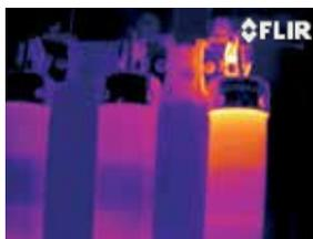
*Innere Beschädigung einer Sicherung*
