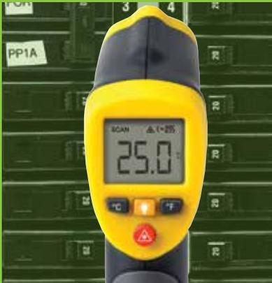
*IR-Thermometer, Temperaturmessung an einem Punkt*
