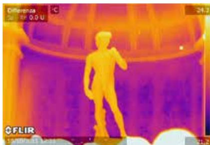
*Dieses Wärmebild zeigt die unter der Oberfläche liegende Struktur der Wände und Pfeiler der Apsis.*
