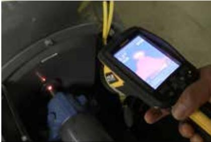
*Untersuchung einer mechanischen Komponente*
