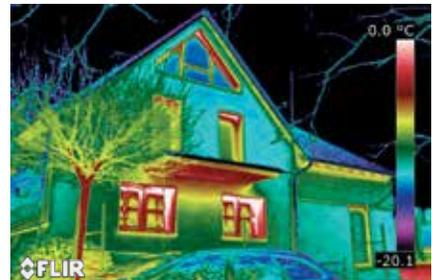
Mit Wärmebildkameras lässt sich sehr gut überprüfen, ob Reparaturen an der Gebäudedämmung fachgerecht ausgeführt wurden.
