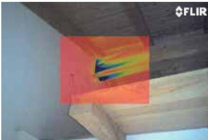
Luftundichtigkeit während der Inspektion mit dem Differenzdruckverfahren, Bild-im-Bild-Darstellung
