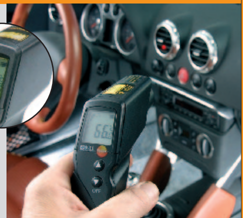
Temperaturkontrolle an einer Lüftung
