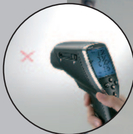
Switch-Optik 1: Fernfeld 75:1 (16 mm, Abstand 1200 mm) mit Kreuzlaser-Markierung
