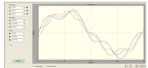
C300B Ausgangssignale mit Digitaloszilloskop Spannungseinbruch
