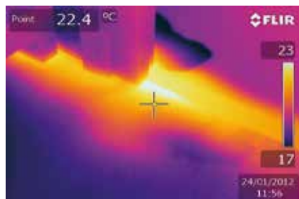
Auf dem Wärmebild ist deutlich erkennbar, dass eine im Boden verlegte Warmwasserleitung undicht ist.
