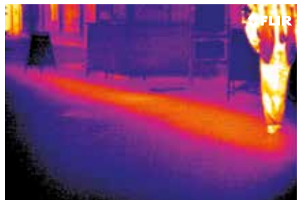
Wärmebildkameras machen die unterirdischen Rohrleitungen eines Fernwärmenetzes deutlich sichtbar. Undichtigkeiten im Leitungsnetz können problemlos entdeckt werden.
