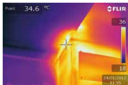
Hinter der Wand versteckte Warmwasserleitungen sind undicht. In diesem Fall ist der Wasserschaden anhand sichtbarer Zeichen erkennbar. Die Wärmebildkamera hilft bei der Lokalisierung der Position der Undichtigkeit.
