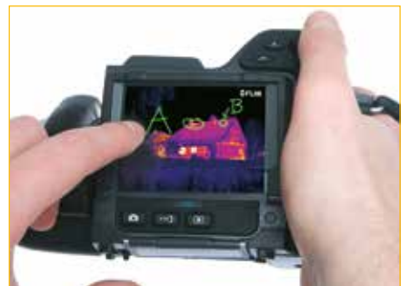
Wärmebild desselben Gebäudes, jetzt mit der MSX-Funktion. Beachten Sie, dass jetzt mehr Details sichtbar sind. Dadurch lassen sich Lüftungsgitter einfacher lokalisieren und die Backsteinstruktur wird erkennbar.
